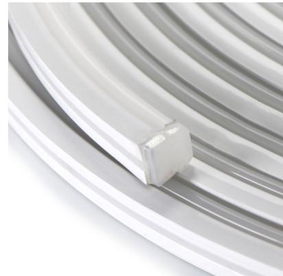
Este neón **se puede cortar cada 25 mm** por su zona habilitada y **se conecta directamente a una fuente de alimentación** con salida a **24V**.
