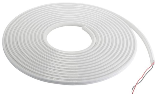
**Neón de LED Flexible de 24V** con acabado en opal y con un índice de protección **IP65**. Se presenta en rollos de 10 metros y contiene 12W por metro de potencia, por lo que proporciona **120W**. Es ideal para zonas de exterior y se usa, mayoritariamente, en letreros ya que, **gracias a su flexibilidad, podrás crear letras corporativas.**
