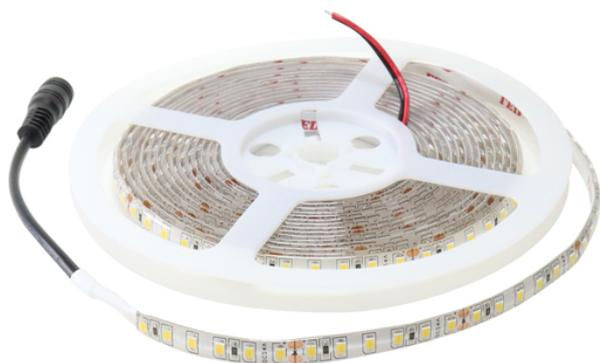
Tira de LED a **24VDC** con acabado en **pcb blanco y con protección IP65**. Cuenta con una banda autoadhesiva que facilita su colocación. El tipo de LED es el SMD2835 con 9W por metro y proporciona una **alta luminosidad** gracias a sus **800 lúmenes**. Es ideal para **proyectos exigentes** y se presenta **en rollos de 5 metros**. **Los cortes se realizan cada 3 cm.**
