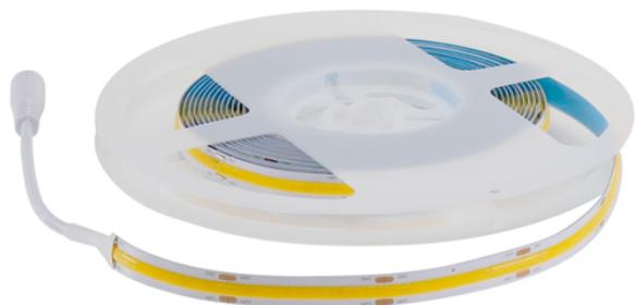
**Tira LED de 24V fabricado en PCB y acabado en blanco.** Se presentan en paquetes de 5 metros y cuentan con una **banda autoadhesiva que facilita su instalación.** El tipo de LED es el COB-308L, que cuenta con **12W de potencia/metro** y con una **luminosidad de 900 LM/m.** Además, **iluminan de manera uniforme** sin notarse los cortes, ni los módulos LED. **Los cortes se realizan cada 4,5 cm.**
