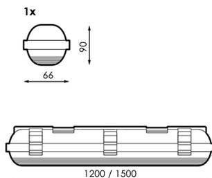
Pantalla estanca para un tubo de 150 cm de longitud. Cuenta con clips de acero inoxidable para su sujeción en el techo y un reflector de chapa pintado en blanco.
