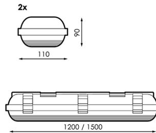
Pantalla estanca para dos tubos de 150 cm de longitud. Cuenta con clips de acero inoxidable para su sujeción en el techo y un reflector de chapa pintado en blanco.
