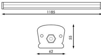
Regleta LED de alta potencia, luminosidad y eficiencia.
