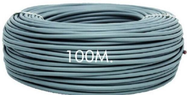
Rollo de 100m compuesto **por un conductor de cobre pulido flexible de clase 5**. El aislamiento está compuesto por **poliolefina tipo TI 7**. La tensión de servicio tiene un **rango de 450 / 750 V**, la tensión de ensayo es de 2.500V. Por otro lado, tiene una **garantía de dos años**.
