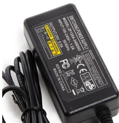
Este transformador se puede instalar directamente a las tomas de corriente suministradas por la red eléctrica (100-240VAC).
