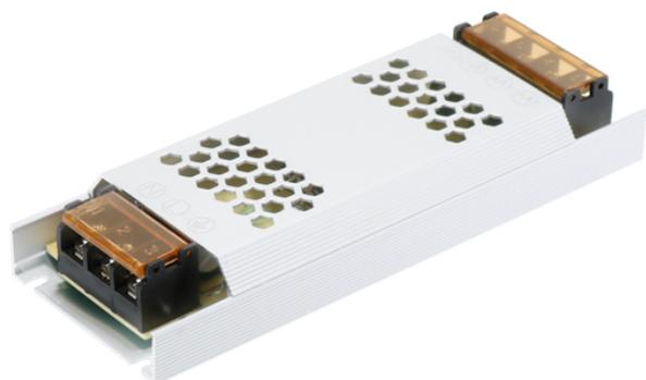
Fuente de alimentación **para Tiras LED 60W 12VDC** de voltaje constante y alta eficiencia. Permite la refrigeración por convección natural del aire gracias al aluminio y su carcasa perforada. Además, puede ser instalado en zonas de poco espacio gracias a su **diseño delgado y ultrafino**. Una de sus funciones principales es que el LED no reciba picos de corriente o tensión.
