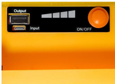
La batería es de **litio de 5V**, posee una **autonomía de 8 a 36 horas** y se puede cargar con el **cable USB** que viene incluido. A parte, esta se encuentra en la placa solar que está colocada en la parte trasera del foco. **Los lúmenes que proyecte el foco variará en función del estado de la batería.**
