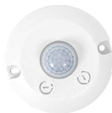
Los sensores de movimiento se activan cuando el aparato **detecta movimiento o alguna presencia en su área de alcance**. En este caso, este detector es capaz de reconocer dichos movimientos por **emisiones invisibles infrarrojas** que procedan de cualquier fuente de calor. Su salida de luz se activa una vez percibe dicha fuente de calor y se cierra cuando deja de detectarla.
