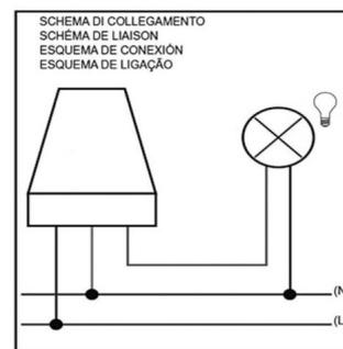
Este sensor **enciende la iluminación automáticamente** al anochecer y desconectarla de la misma forma al amanecer. Además, tiene un **sistema automático de regulación**, por lo que detecta los cambios de iluminación provocados por condiciones meteorológicas, así como las variaciones en la hora de anochecer y de amanecer a lo largo del año.
