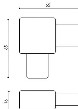
Este accesorio te permite unir carriles monofásicos en esquinas y así adaptar la iluminación a una estancia en concreto.
